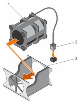
Figure 47. Installing a cooling fan
