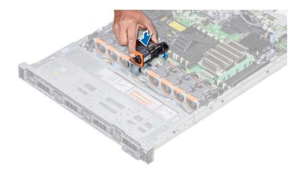
Figure 31. Installing the cooling fan
