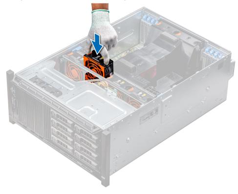
Figure 41. Installing a cooling fan
